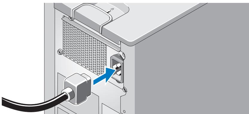
Připojte napájecí kabel(y) k systému. Poté zasuňte druhý konec napájecích kabelů do uzemněné elektrické zásuvky nebo je připojte k samostatnému zdroji napájení, například k jednotce UPS nebo jednotce rozvaděče (PDU).
