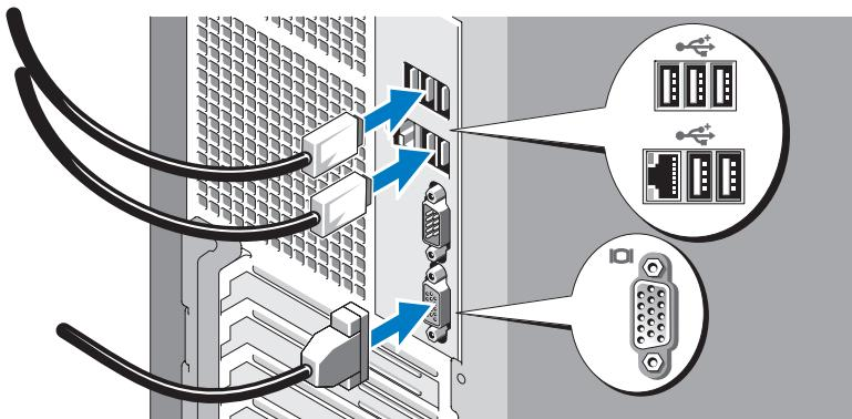
Подключите клавиатуру, мышь и монитор (дополнительно).
