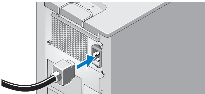
Подсоедините шнуры питания к системе. Подключите другой конец шнура питания к заземленной розетке или отдельному источнику питания, например, к источнику бесперебойного питания или блоку распределения питания.
