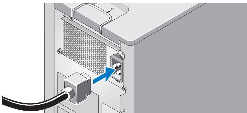
Verbinden Sie das Netzstromkabel mit dem System. Schließen Sie dann das andere Ende des Kabels an eine geerdete Steckdose oder eine separate Stromquelle an, etwa eine unterbrechungsfreie Stromversorgung (USV) oder einen Stromverteiler (PDU).
