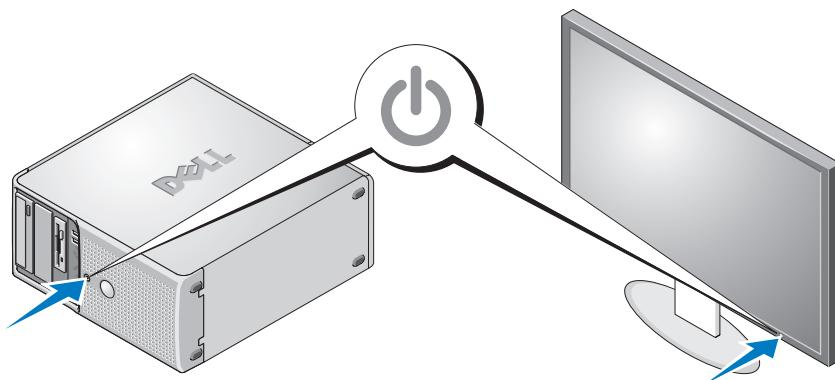
Appuyez sur le bouton d'alimentation du système et sur celui du moniteur. Les voyants d'alimentation doivent s'allumer. Réglez le moniteur jusqu'à ce que l'image soit correctement affichée.
