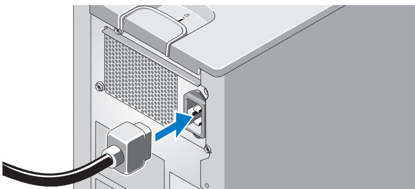
Συνδέστε το καλώδιο παροχής ηλεκτρικού ρεύματος στο σύστημα. Στη συνέχεια, συνδέστε το άλλο άκρο του καλωδίου τροφοδοσίας σε γειωμένη πρίζα ή σε ξεχωριστή πηγή ηλεκτρικού ρεύματος, όπως είναι ένα σύστημα αδιάλειπτης τροφοδοσίας (UPS) ή μια μονάδα διανομής ρεύματος (PDU).
