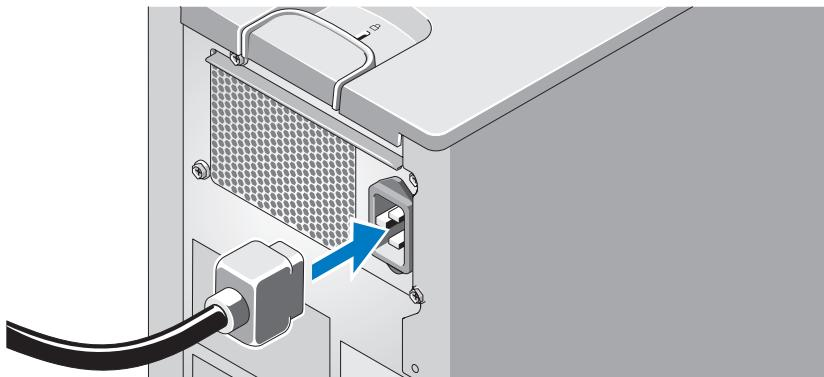
חבר את כבל החשמל של המערכת למערכת. לאחר מכן, לחבר את הקצה השני של כבל החשמל לשקע חשמל מוארך, או למקור חשמל נפרד, כגון מערכת אל-פוק או יחידה לחלוקת מתח (PDU).
